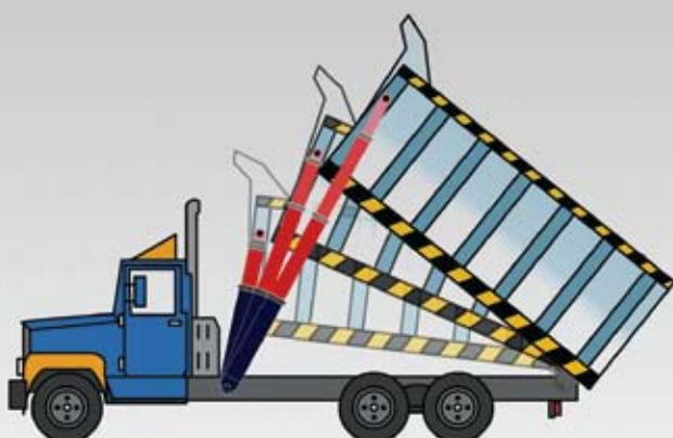
جک تلسکوپی ساده با حرکت غیر یکنواخت و پله‌ای
