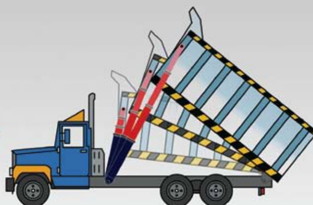
جک تلسکوپی سنکرون با حرکت یکنواخت
